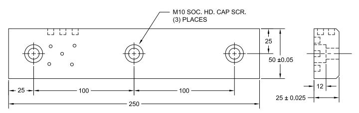
TOLERANCE BETWEEN SCREW HOLES ± 0.12
