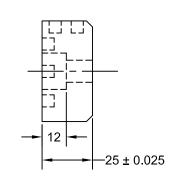
TOLERANCE BETWEEN SCREW HOLES ± 0.12
