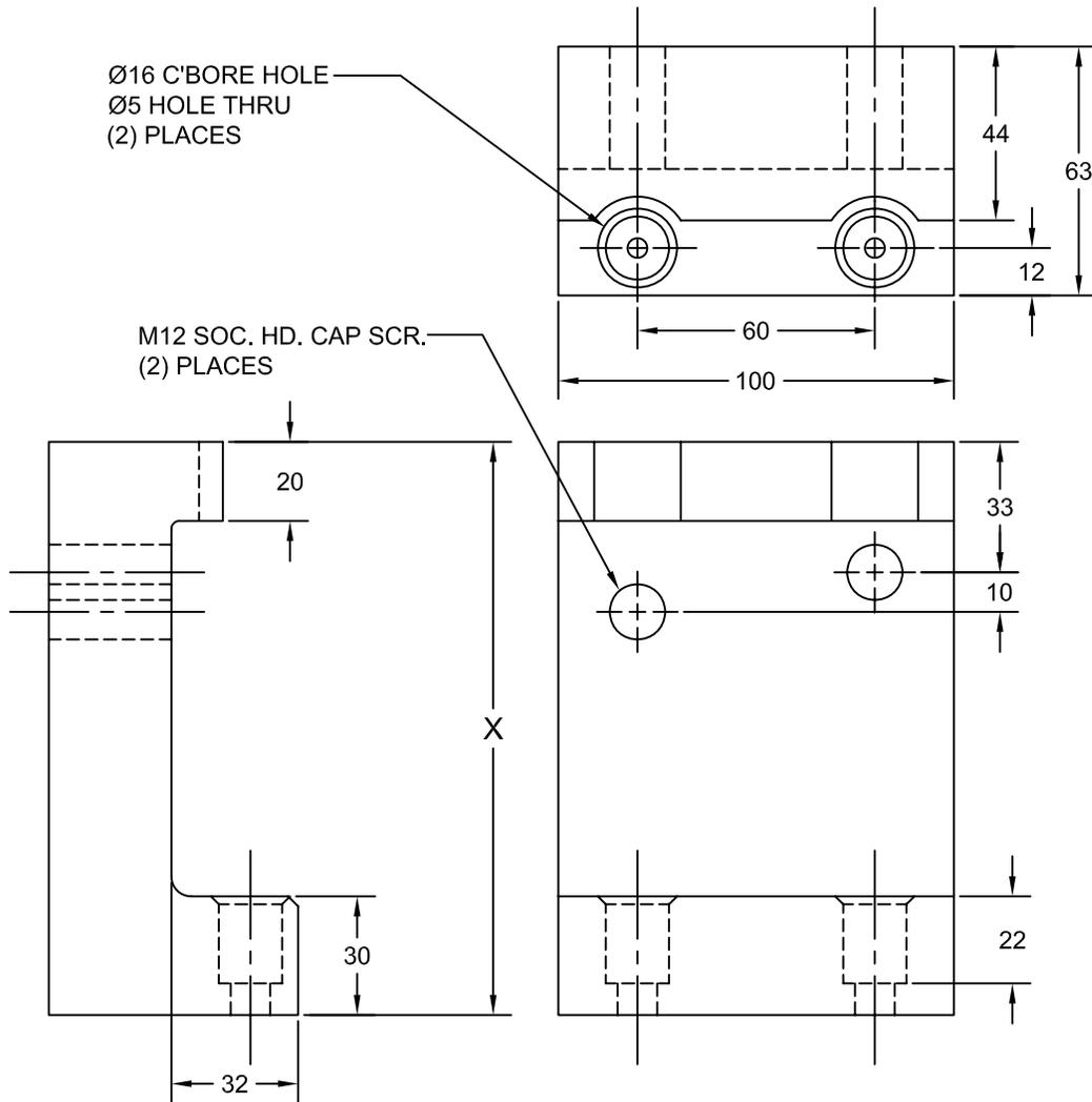
TOLERANCE BETWEEN SCREW HOLES  $\pm 0.25$
